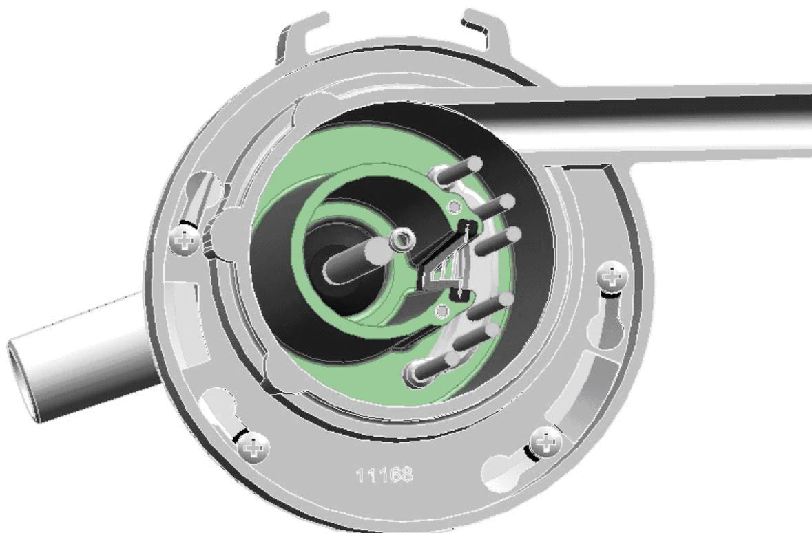
Il flusso di latte è continuamente calcolato sulla base del livello del latte nella camera di misura. Il livello è registrato da due elettrodi. 4 elettrodi addizionali sono posizionati alla base della camera di misura e continuamente aggiustano la misurazione in accordo alla conducibilità elettrica del latte che passa durante la mungitura.
